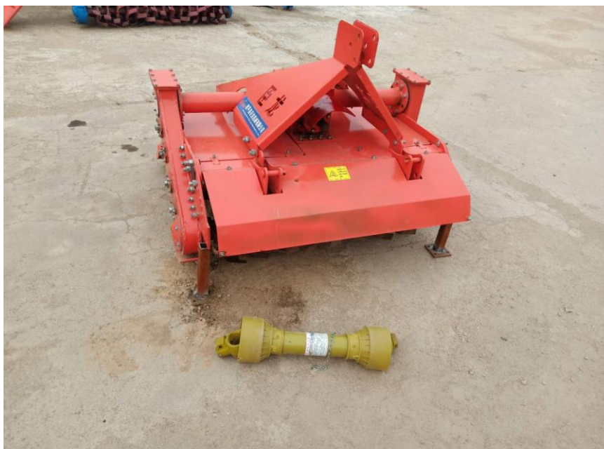
1GKM-110B 型双轴灭茬旋耕机
