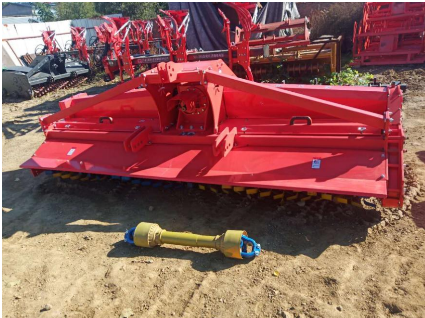
1GZL-300III型旋耕深松灭茬起垄机
